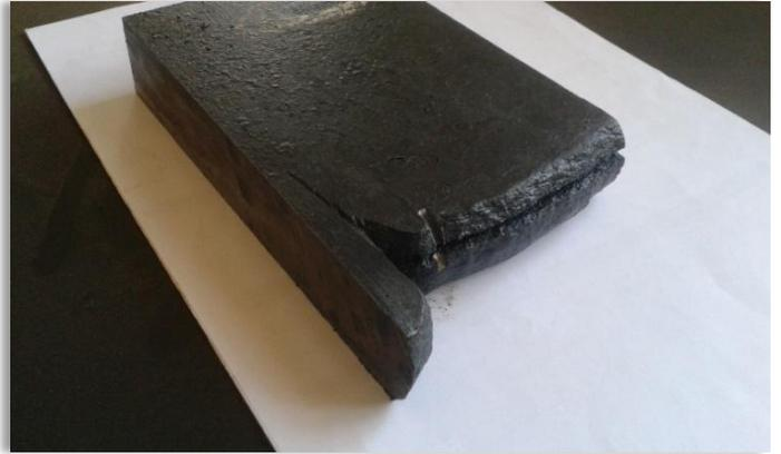
أظهرت نتائج التحليل أن المكونات الكيميائية للعينة مطابقة لمواصفات صلب AISI 1010 أو S235 وهي المواصفة المتبعة بمصنع الدرفلة على الساخن مع ارتفاع نسبي في نسبة الكبريت (S).
